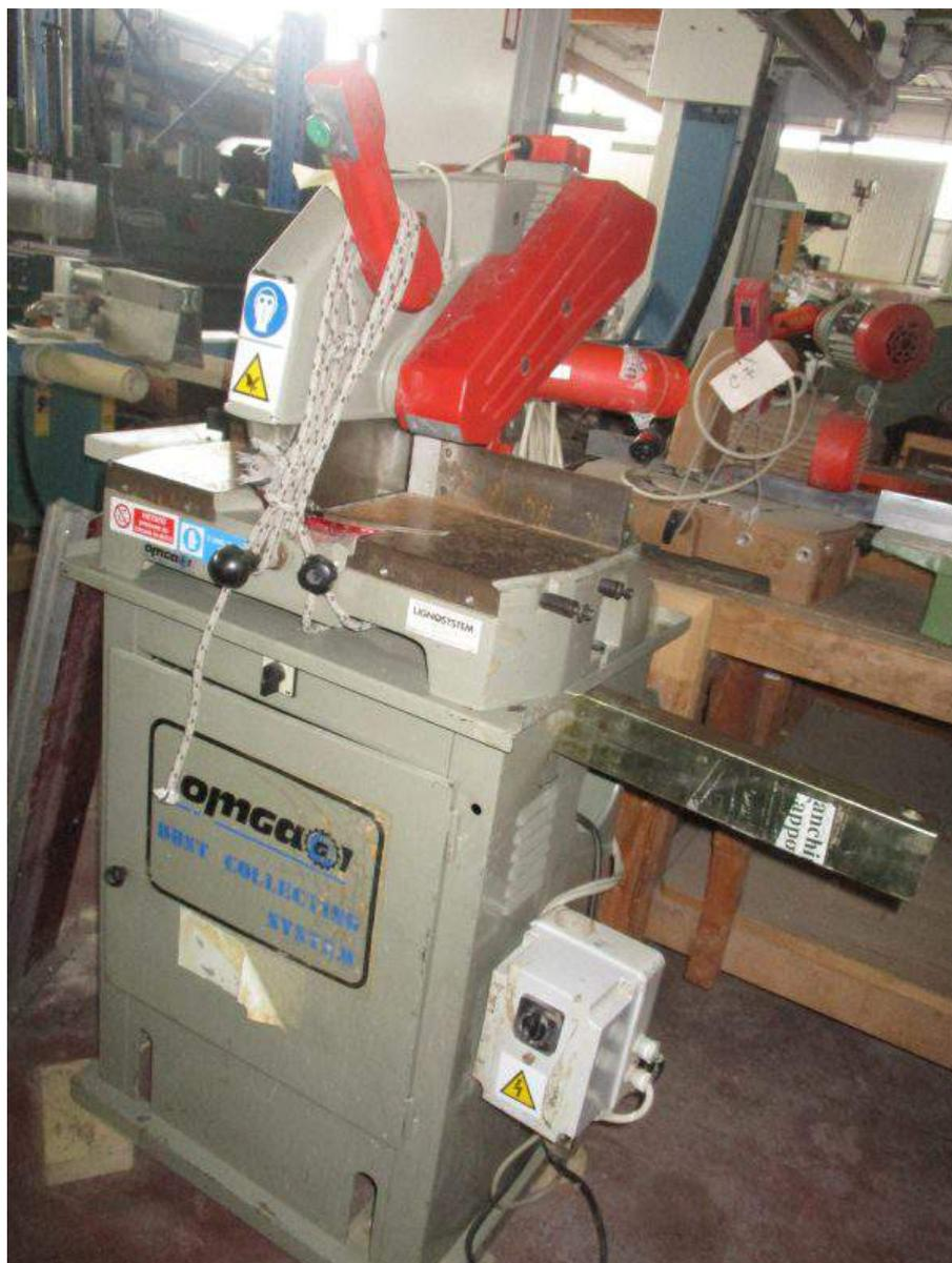
**Descrizione:** TRONCATRICE OMGA mod. T50 350 con basamento aspirante - revisionata - completa di lama nuova
