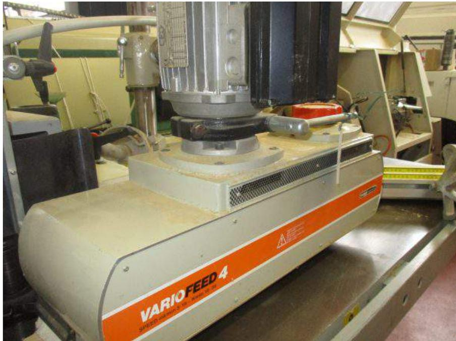
**Descrizione:** TRASCINATORE MAGGI mod. VARIOFEED 4 - a normative CE - n. 4 ruote - feed mt./min 3-18 - ft/min 10-59
