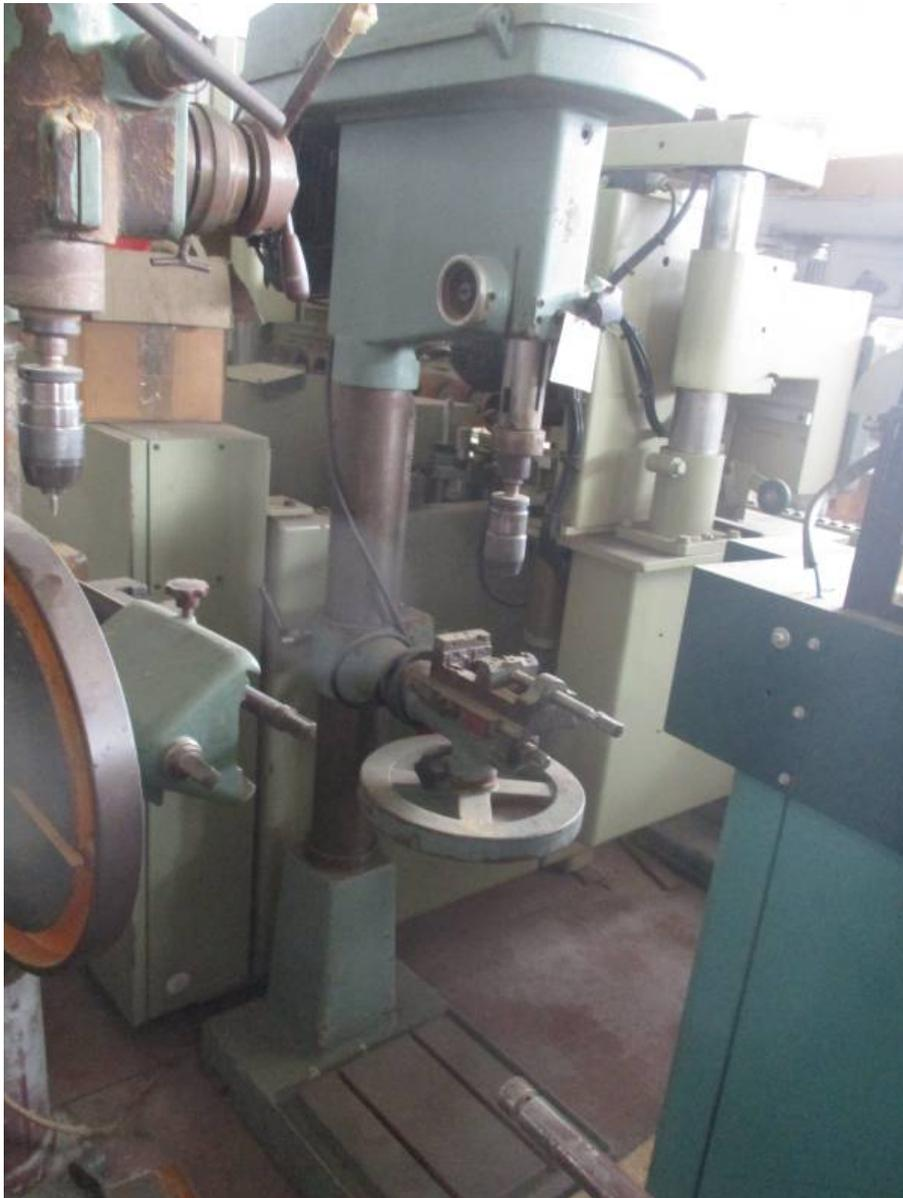
**Descrizione:** TRAPANO A COLONNA - 5 vel. con cambio cinghia - motore 2 velocità: hp 0,8 g7min. 700 hp 1 g7min.1400 - morsa girevole e piatto - v.380
