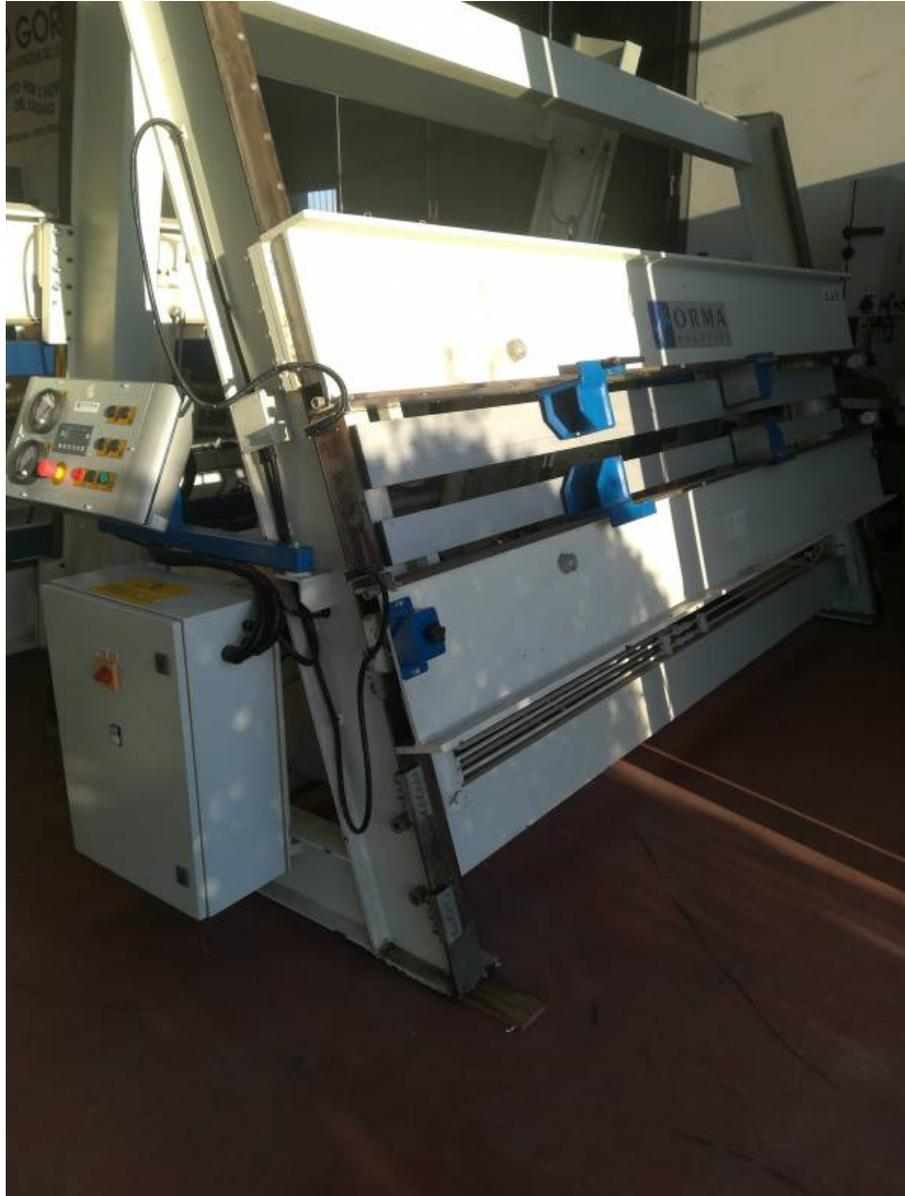
**Descrizione:** STRETTOIO ORMA MOD. FUTURA 30/17 - Dimensioni utili di lavoro mm. 3000x1700 - n.2 pistoni orizzontali 65/45 corsa mm. 1200 - n.2 pistoni verticali 65/45 corsa mm. 800 - Spinta tot. Pistoni verticali ton. 14 - Spinta tot. Pistoni orizzontali ton. 6 - carter su cremagliera
