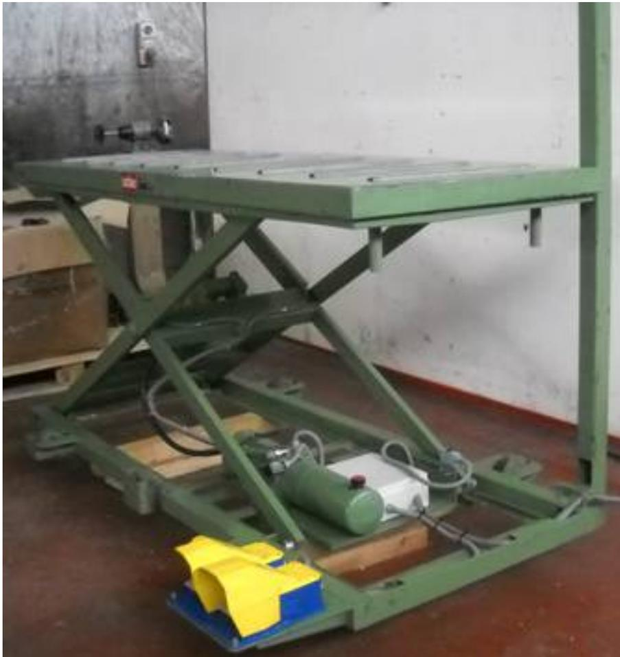
**Descrizione:** SOLLEVATORE IDRAULICO CASSIOLI - da mm. 2000x750 - con ruote traslanti
