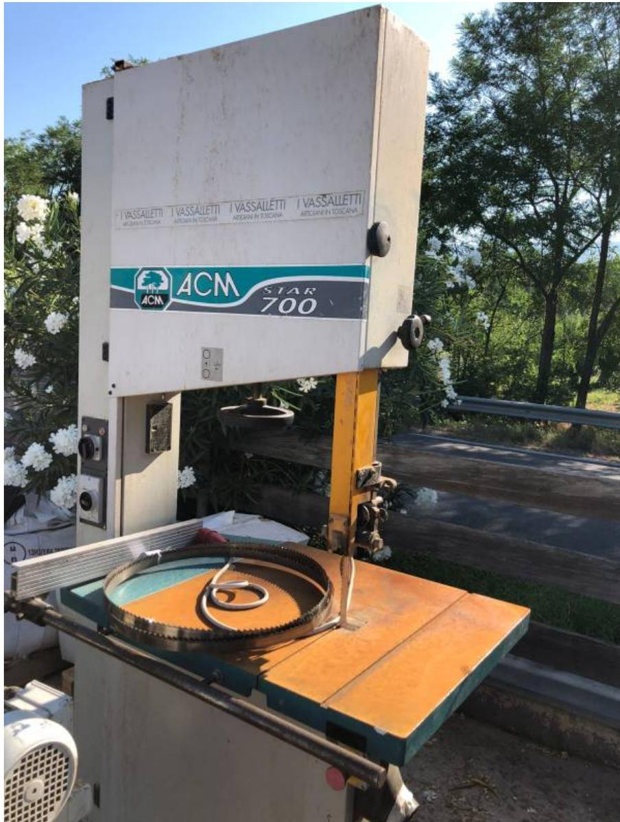
**Descrizione:** SEGA A NASTRO ACM MOD. STAR 700 - a normative CE - lunghezza lama max mm. 5040 - lunghezza lama min mm. 4990
