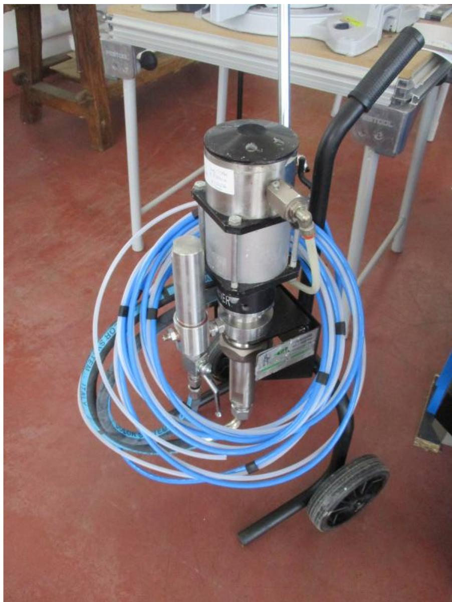
**Descrizione:** POMPA DI VERNICIATURA - a norme CE Completamente revisionata. Sostituito: - pistola airmix mach 3 completa - tubo aspirazione 36x - 1/2 - tubo binato airmix 1/4 - 3/16x7,5 - tubo ritorno M20x2 - ministaccio 1/2 - kit guarnizioni calotta - kit guarnizioni pistone
