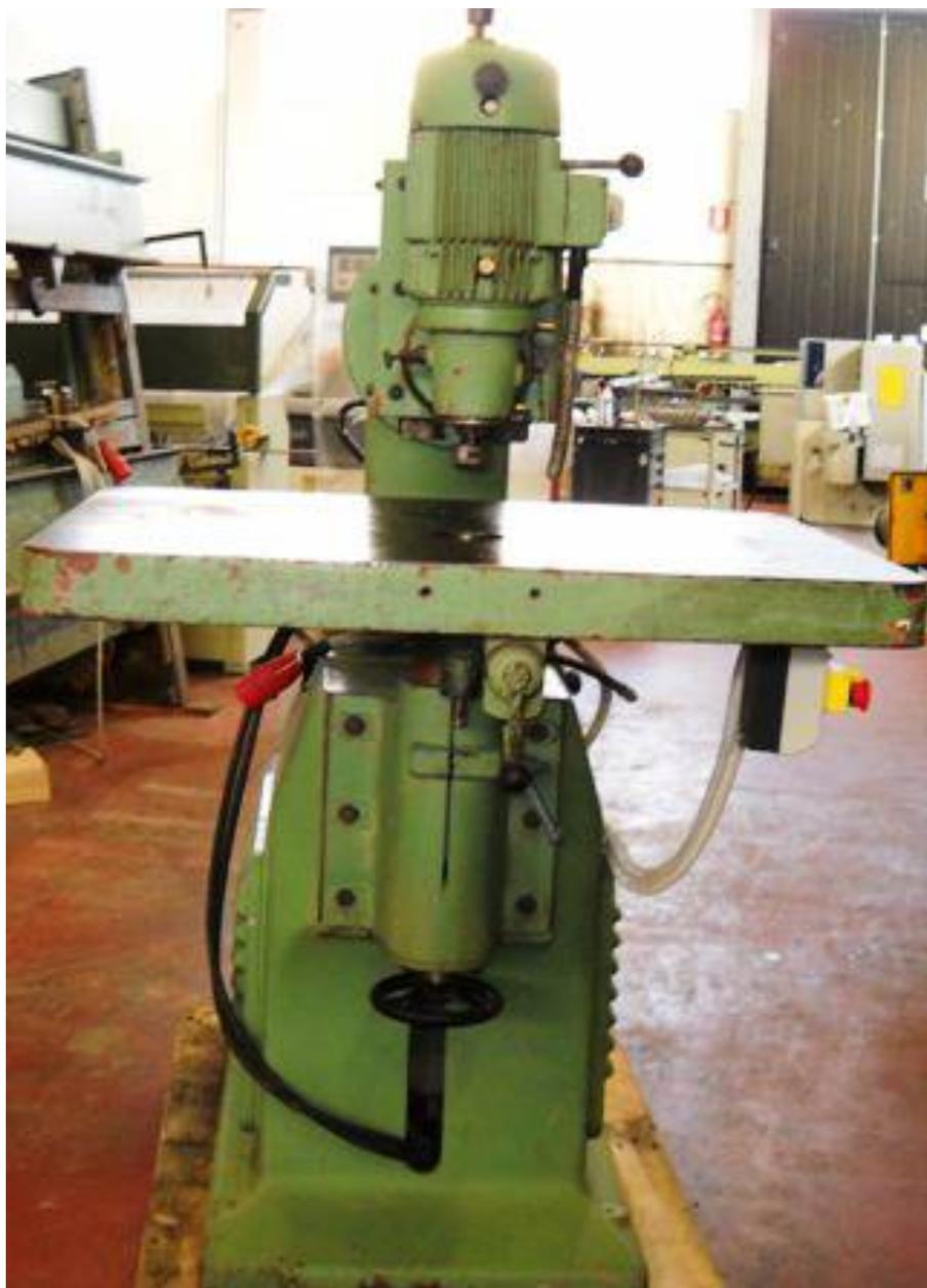
**Descrizione:** PANTOGRAFO VITAP - da 700 - discesa meccanica
