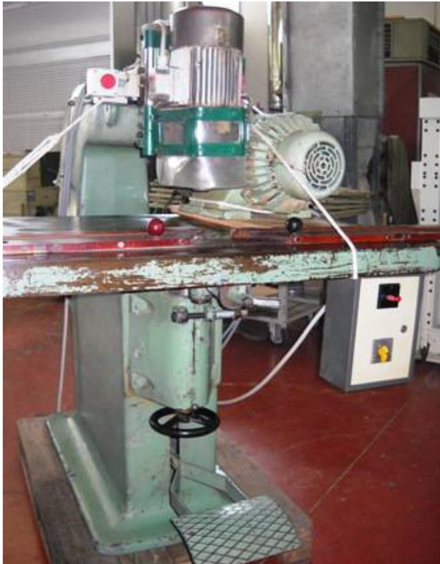
**Descrizione:** PANTOGRAFO OFG - con convertitore - sbraccio da mm. 900 - discesa meccanica - potenza elettromandrino hp5,6 g.min.12.000-18.000
