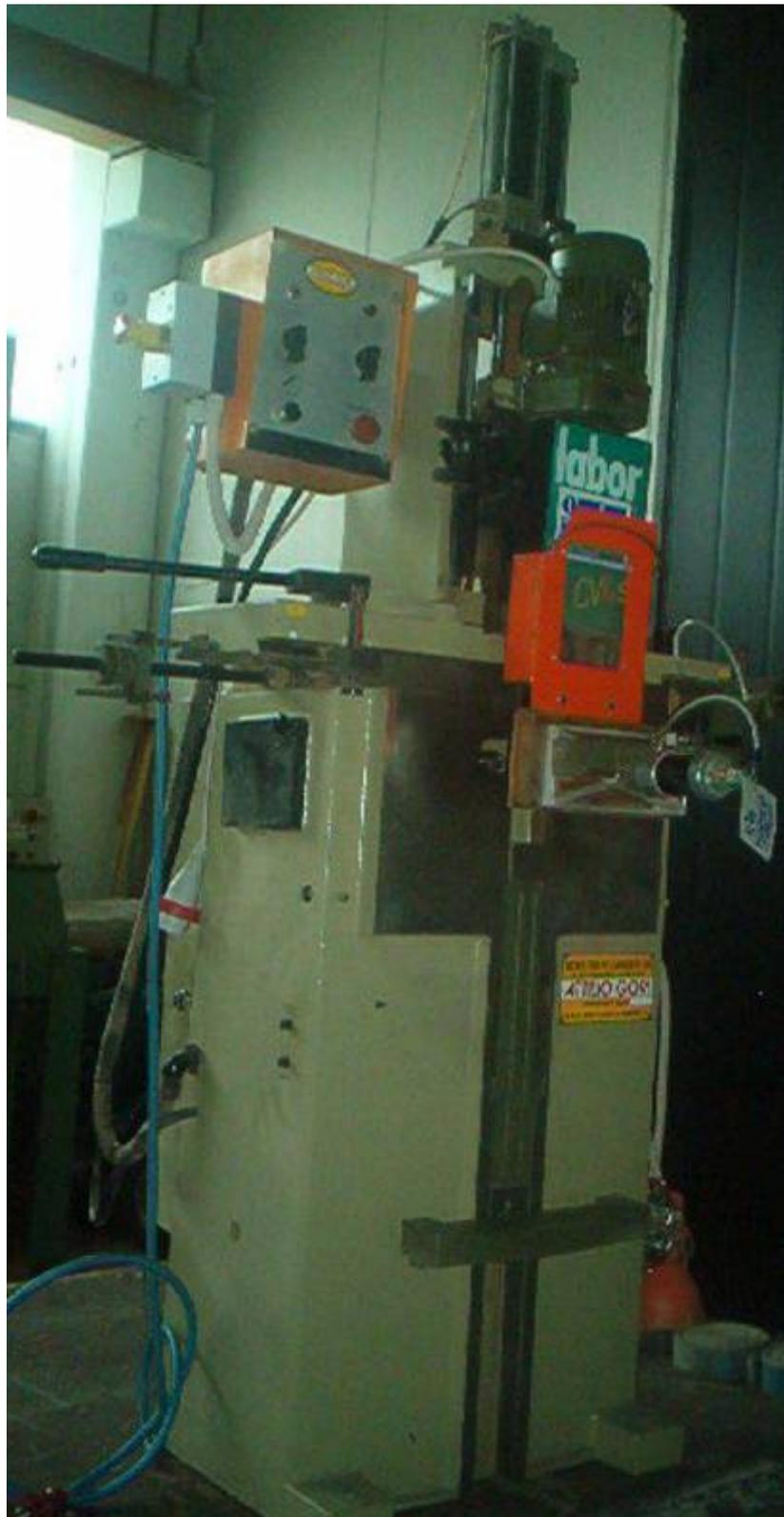
**Descrizione:** MORTASA A CATENA LABOR MOD. CV4S - discesa aut.ca - traslazione manuale - uscita punte aut.ca
