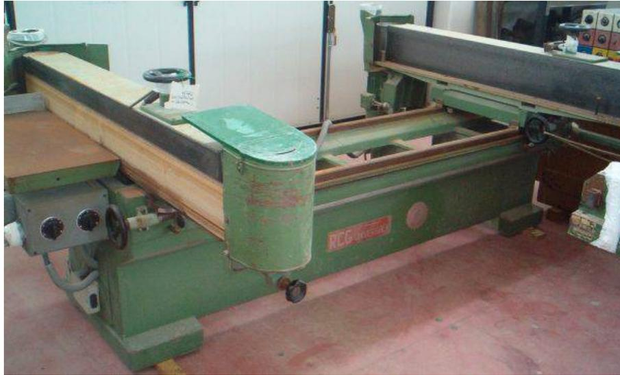
**Descrizione:** LEVIGATRICE PER CASSETTI RCG 200A GALLI UNIVERSALE - sv. nastri mm. 4450x250 - apertura mm.2000 - motori hp 10 - con inversione di rotazione
