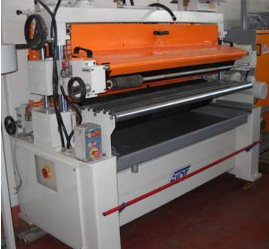
**Descrizione:** INCOLLATRICE FIN MOD. SC4/1300 - a norme CE - completamente revisionata - a 4 rulli da mm.1300 - con lavatori - passo 1,2/1,3 prof.7/10 - per cm.2,5 ci sono 17 gole e 17 dentini - larghezza di lavoro mm.1300 - passaggio massimo fra i rulli mm. 120 - diam. dei rulli mm.250 - velocità di avanzamento mt./1' 19 - potenza di ciascun motore hp 1 - dimensioni ingombro: \*lunghezza mm. 2300 \*larghezza mm. 1100 \*altezza mm. 1700 - peso kg. 900
