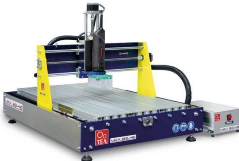
**Descrizione:** FRESATRICE CN DA BANCO SERIE MAX - motore 1050 Watt Reg.220v - corsa X 800 - corsa Y 450 - corsa Z 100 - viti e guide a ricircolo di sfere - piano standard in multistrato - collegamento con linea seriale x PC (PC non fornito) - piano di lavoro in alluminio con cave a T.
