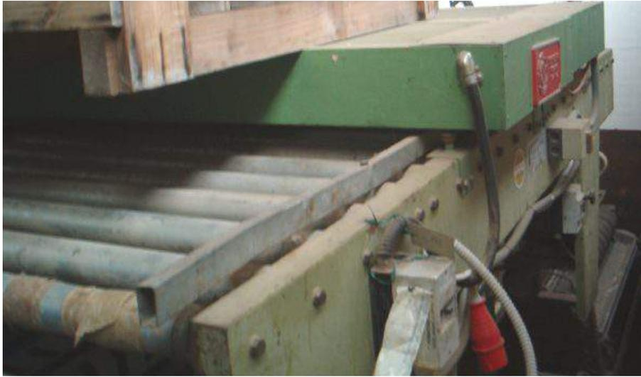
**Descrizione:** FORNO A LAMPADE CVM ES 7,5 POTENZA KW 7,5 A 6 LAMPADE RULLIERA
