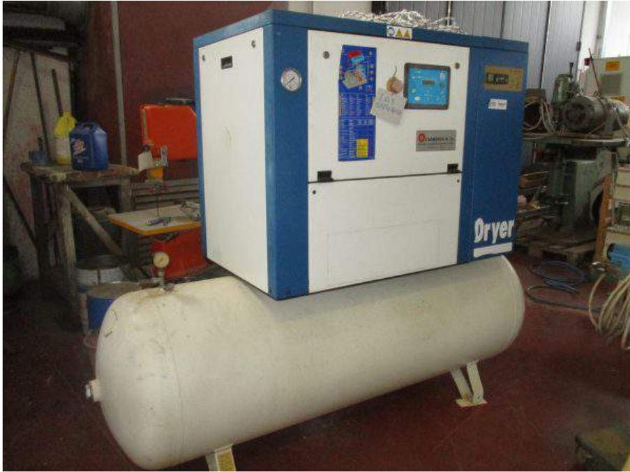
**Descrizione:** COMPRESSORE FIAC MOD. CRSD15/500 - a normative CE - aria resa L/min. 1450 - ampere max 21,1 v.400/50/3 - pressione max bar 10 - potenza assorbita kw 12,9 - peso kg. 456
