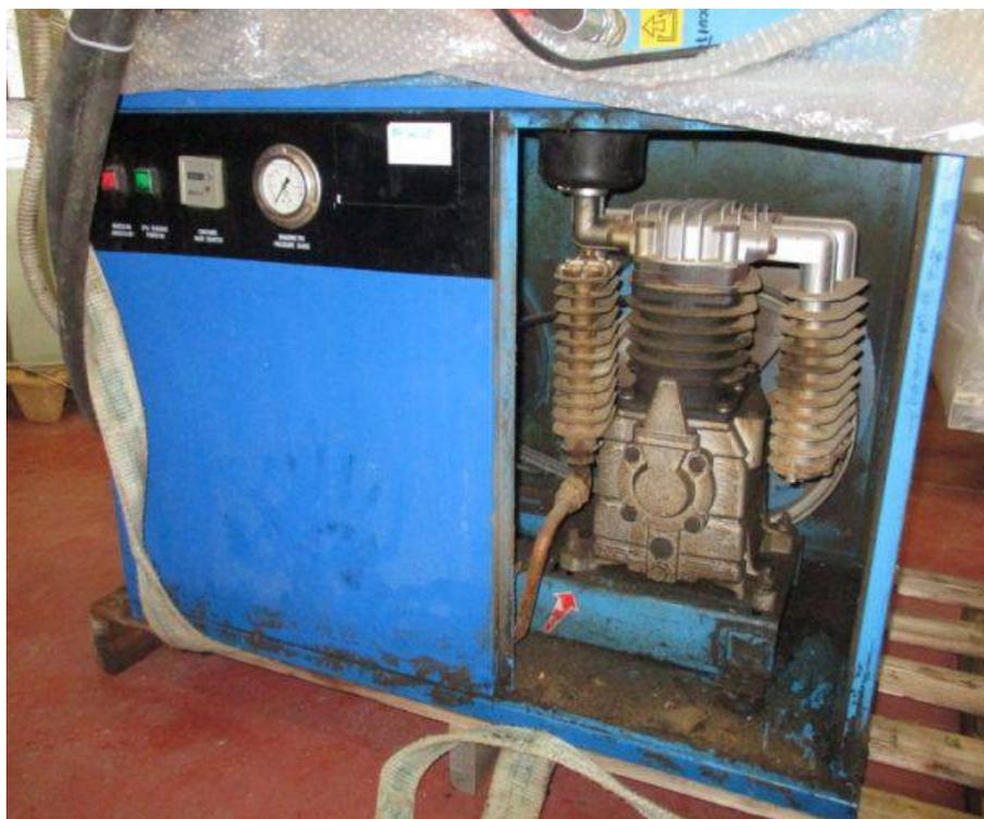
**Descrizione:** Compressore CE 0302 - a norme CE - silenziato - pressione max esercizio PS 11 Bar
