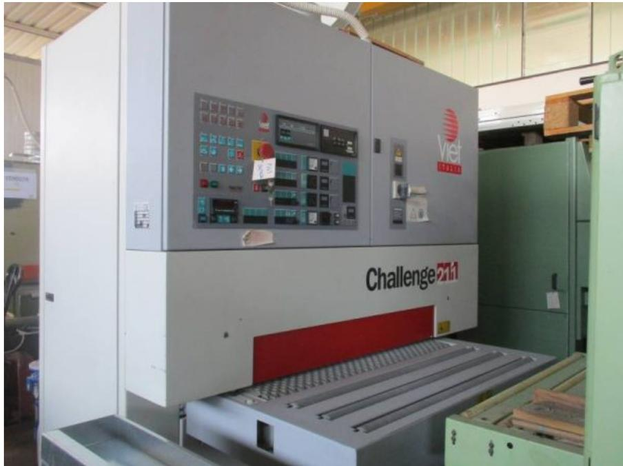
**Descrizione:** CALIBRATRICE VIET MOD. CHALLENGE 211 T.EL. da 1100 - primo rullo mm. 240 24 SH - tampone 24 settori \* adatto per impiallacciatura - motore hp 15 con variatore - soffiatore su entrambi i nastri - tappeto depressione - tampone sezionato elettronico - rulliera entrata e uscita
