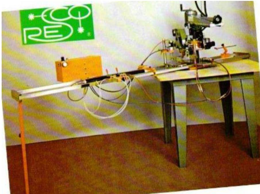
**Descrizione:** APPARECCHIO PER RADIALE RESCO 82 Apparecchio divisore universale aut.co brevettato "resco 82". Applicabile su seghe circolari radiali per realizzare scanalature, sagomature e fresature su regoli e pannelli in legno e plastica con rotazione del supporto porta pezzi da 0° a 45° a destra e sinistra rispetto all'asse neutro del piano orizzontale.
