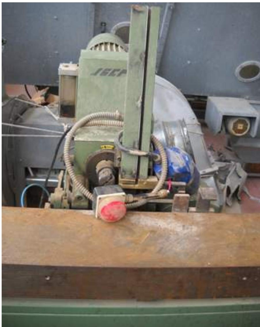
**Descrizione:** ANUBATRICE SICAR MOD. SGCP FA1P - con posizionatore con controllo per posizionamento testa e avviamento ciclo - a 1 testa - attrezzata per anuba da 14 (?)
