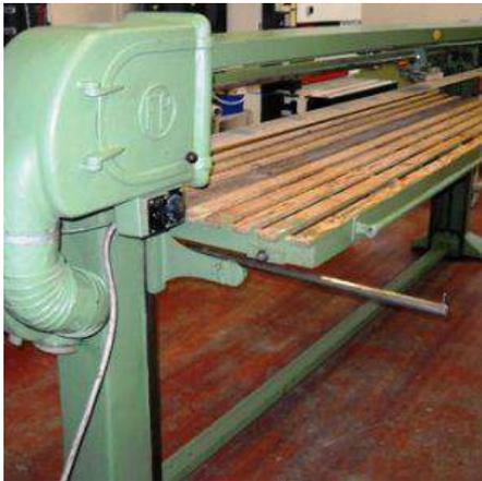
**Descrizione:** LEVIGATRICE A NASTRO FP - da mt. 3 - motore 2 velocità 1410-2830
