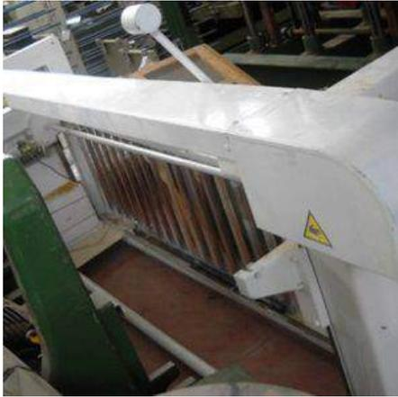
**Descrizione:** LEVIGATRICE A NASTRO MABO MOD. SPECIAL - da mt. 3 - doppio collo d'oca - basamento in acciaio - sollevamento motorizzato del piano - motore a due velocità 1450-2900 da hp 2/3 - puleggia diam. 200 larghezza mm. 160
