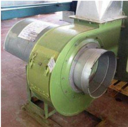
**Descrizione:** ELETTOVENTILATORE CON PROTEZIONE MOTORE - raccordi esistenti diam. 350 entrata e uscita - MOTORE kw 7,5 hp 10 \*r/min.2900 \*A stella triangolo 14,14-8,2 \*v400-690 - VENTOLA STIAVELLI kw 7,5 2Pb3
