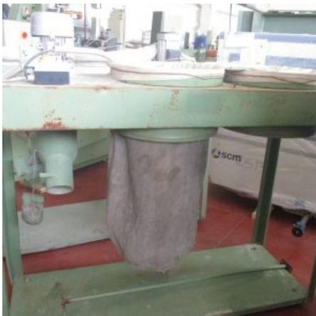
**Descrizione:** FILTRO VISCAT FULGOR MOD. EC2/3 - a norme CE - potenza kw 1,84
