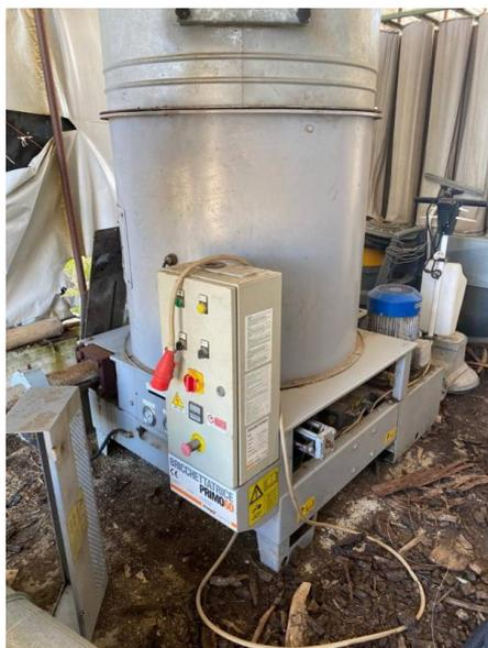
**Descrizione:** BRICCHETTATRICE PRODECO MOD. M 60 - bricchetto diam. 60 - viola diam. mm. 1000 con sportello d'ispezione - motore kw 55,5 h 7,5 - prolunga x viola h. mm. 800 con sportello d'ispezione
