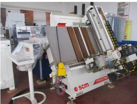
**Descrizione:** CENTRO DI LAVORO SCM MOD. CYFLEX F900 - a norme CE - gruppo statico di continuità - supporti laterali per lavorazioni di pezzi lunghi - lubrificazione aut.ca di controllo
