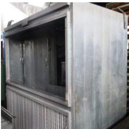
**Descrizione:** CABINA DI VERNICIATURA - dimensioni mm. 1800x1050x2150 h - a secco
