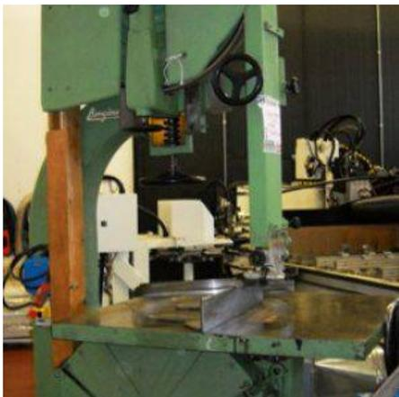
**Descrizione:** SEGA NASTRO BONGIOANNI - da mm. 900 - potenza motore kw7,5 - volani pieni
