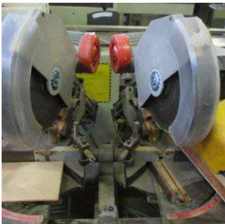
**Descrizione:** Troncatrice doppia Omega mod. TR2A - apertura mm. 2800 - lama diam. 300 - discesa pneumatica teste - motori kw 1,6 cad.
