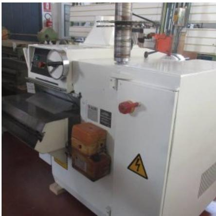
**Descrizione:** MULTILAME SCM MOD. M3 - con guida programmabile - motore hp 35
