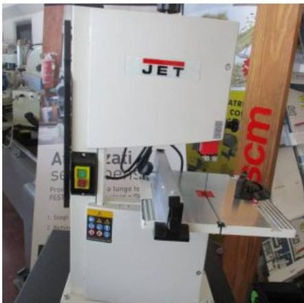
**Descrizione:** SEGA A NASTRO GAMMA ZINKEN MOD. JWBS 9x - altezza max di taglio mm. 80 - sv. lama mm. 1575 - larghezza lama mm. 3-10 - inclinazione tavola +0° -45° - potenza motore 220V 350W - peso 17 kg.
