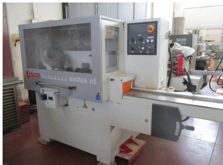
**Descrizione:** PIALLATRICE PROFILATRICE AUT.CA SCM MOD. SINTEX NT - a norme CE Composizione: - ALBERO PIALLA - ALBERO VERTICALE DX - ALBERO VERTICALE SX - ORIZZONTALE SUPERIORE - piano d'entrata mm. 2500 - regolazione motorizzata dell'altezza di lavoro - gruppo d'avanzamento prima della pialla con leva di esclusione
