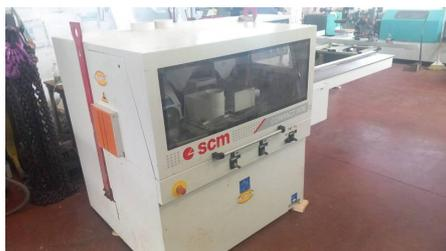
**Descrizione:** SCORNICIATRICE SCM MOD. COMPACT NTE - a norme CE COMPOSIZIONE: 1) ALBERO PIALLA ORIZZONTALE INFERIORE 2) VERTICALE DX 3) VERTICALE SX 4) ORIZZONTALE SUPERIORE - freni motore - variazione traino inverter - pressione pneumatica - piano mm. 2500 - kit per larghezza min. di lavoro
