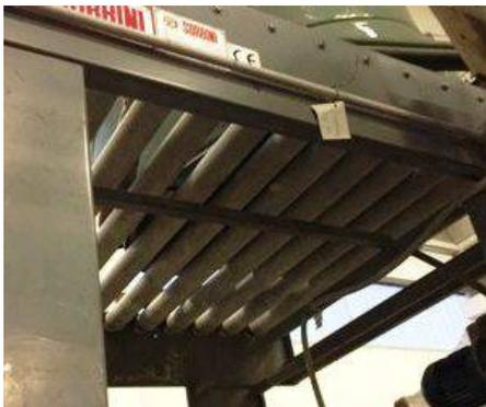
**Descrizione:** RULLIERA MOTORIZZATA MOD. TRANSFER T 20 R - a norme CE - dimensioni larghezza mm. 1530 (utile mm.1420) x lunghezza totale mm. 2000 - altezza con piedino cm. 91 - altezza senza piedino cm. 86 - motore kw 0,4 v380/50 - n.8 rulli al mt. (per un totale di n.16 rulli) diam.80 interasse 22,5 lunghezza mm. 140 - lunghezza da rullo a rullo cm. 194
