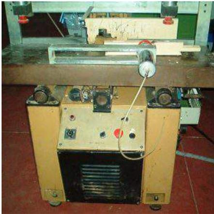
**Descrizione:** BEDANATRICE MUTI MOD. OMB1-ECO - automatica - a una testa - motore hp3 2 poli - profondità max della cava 130 mm. - regolazione verticale della testa 100 mm. - dimensioni della tavola 1000x300 mm. - altezza del piano di lavoro 820 mm. - pressione di lavoro 6-8 bar - consumo aria per ciclo lt. 15
