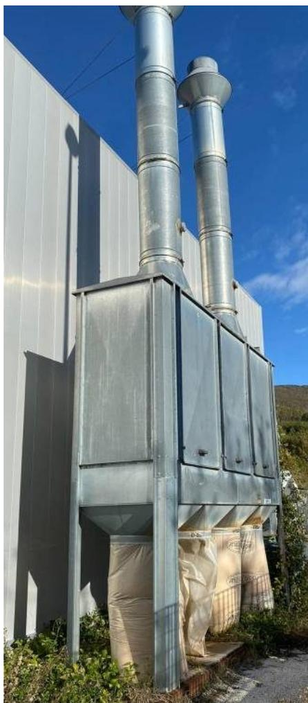
**Descrizione:** ASPIRATORE ASPIRMECC TIPO AM4764 CS - a norme CE - portata mt./cubi h.10500 - potenza kw 11
