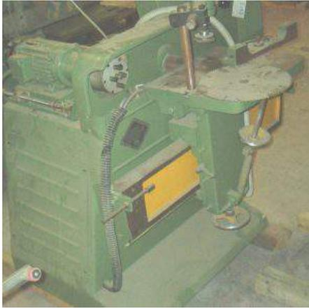
**Descrizione:** FORATRICE / INTESTATRICE A 5 PUNTE PADE MOTORE LAMA HP 3 MOTORE PUNTE HP 3 CON CARRO PRESSORE PNEUMATICO
