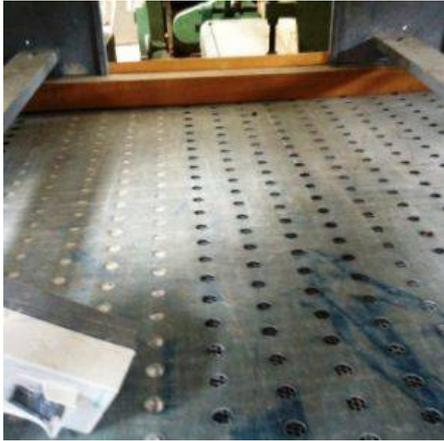
**Descrizione:** TAPPETO FORATO MOTORIZZATO SORBINI MOD. TRANSERT 35 B - a norme CE - da mm. 3500x1400 - motore kw 0,8 v380 - con cassetto di pulizia - avanzamento con motovariatore
