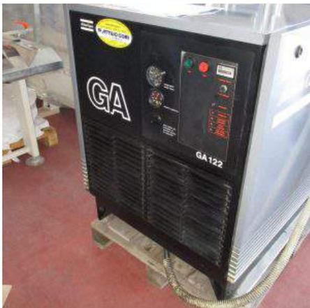
**Descrizione:** COMPRESSORE ATLAS COPCO MOD. GA122 - kw 22 bar 7,5 -
