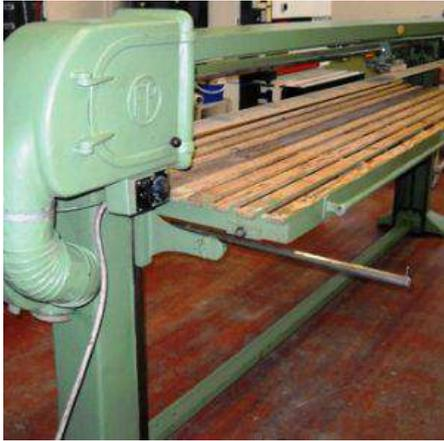
**Descrizione:** LEVIGATRICE A NASTRO FP - da mt. 3 - motore 2 velocità
