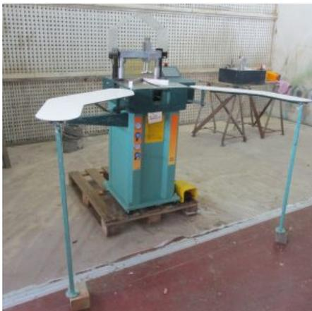
**Descrizione:** Aggraffatrice elettronica Motta Brevetti Mod. AUT 2000 - dimensioni max delle aste lavorabili mm.120 (4 3/4") - produzione oraria possibile circa 250 cornici
