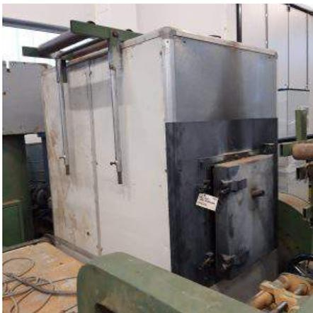
**Descrizione:** Impianto di riscaldamento con caricamento automatico METALREF Composto da: 1- Bruciatore-caldia 2- Macinatore 3- Coclea-caldia 4- Coclea 5- Coclea 6- Ventilatore 7-Ciclone + valvola stellare 8- kit Quadro elettrico
