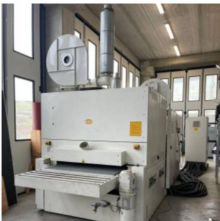
**Descrizione:** Calibratrice levigatrice Marca DMC Inferiore + Superiore Modello Linea compatta UNISAND K/I RRRR + UNISAND K RRRR Larghezza utile di lavoro 1350 mm Spessore di lavoro da 4 a 170 mm Altezza di lavoro fissa 900 mm Pannello di Controllo PLC modello Hydra C-Pad, monitor touch-screen 10,4''
