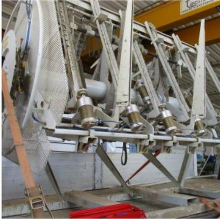
**Descrizione:** STRETTOIO ROTATIVO STROMAB MOD. ST 2500 - utile di lavoro: \*spessore min. mm. 15 \*spessore max mm. 120 - anno 2000 - lunghezza utile mm. 2500 - altezza utile mm. 1200 - cilindri verticali per ogni postazione di lavoro n.6 - pressori fontali per ogni postazione di lavoro n.3 - spinta cilindro verticale a 8 bar kg.400 - capacità produttiva giornaliera (8 ore) m2 220 - misure ingombro: \*lunghezza mm. 3350 \*larghezza mm. 2000 \*altezza mm. 2300 - peso kg. 950
