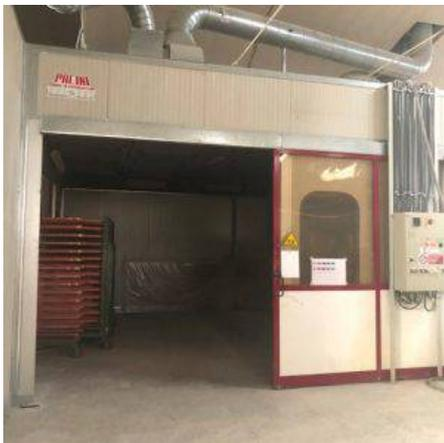
**Descrizione:** Cabina di verniciatura Pacini ad acqua - con stanza di appassimento da mt. 6 - solo pannello e parete - non pressurizzata - modificata a secco - tutta smontata
