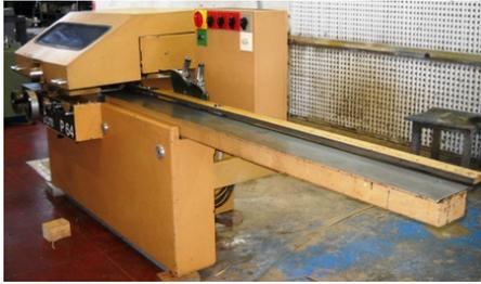
**Descrizione:** PIALLATRICE SCM MOD. P64 - macchina funzionante - completa di frese
