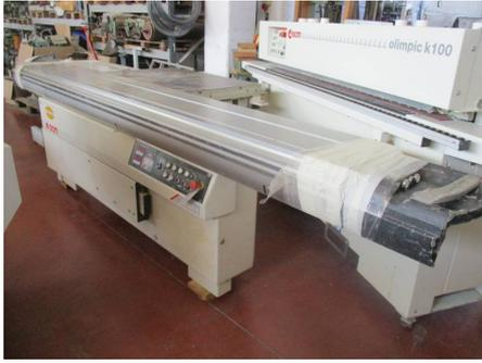
**Descrizione:** SEGA CIRCOLARE SCM MOD. SI350 E - carro da mm. 3200 - a norme CE - pulsanti marcia/arresto integrati nel carro scorrevole - guida a squadra "quick look" con rullo esten. - guida parallela con posizionatore elettronico - diam. albero sega 30 mm
