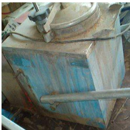
**Descrizione:** DISTILLATORE MOD. CMK2 - v.220 - motore kw 1,2 - ciclo di lavoro h.2
