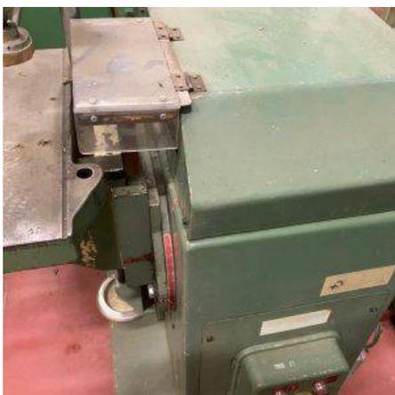
**Descrizione:** MORTASATRICE PADE MOD. MSO - semplice aut.ca oscillante (avanzamento della tavola - punta oscilla) - n. 1 punta - carico e scarico manuale Dati tecnici: - attacco della punta diam. 13 mm. - lunghezza max della cava mm. 100 - corsa verticale bancale mm. 120 - bancale inclinabile a 25° - profondità max della cava mm. 55 - pressione d'esercizio 6 bar - potenza motore albero portapunte hp3 - potenza motore oscillazione mandrino hp 1,5
